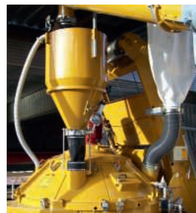
Airbag for minimering af støvudslip.
